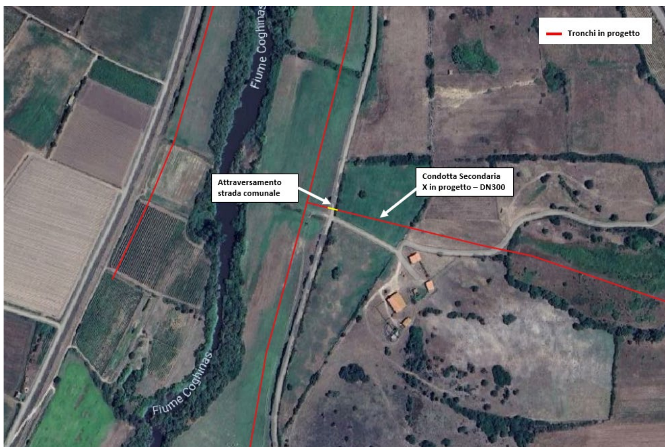
Figura 20 – Attraversamento stradale su passaggio Condotta Secondaria X.
